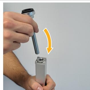
Die Einschlaghülsen (4) in die Profilrohre (10) & (12) stecken. Dann mit einem Schonhammer vollständig einklopfen.
