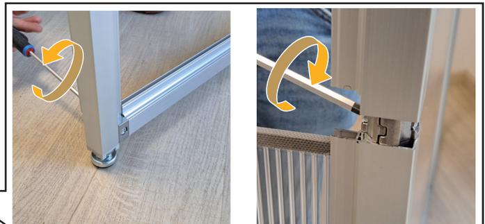
Die Führungsprofile nach der Darstellung auf die Profilrohre schieben. Danach mit den Eck- und Steckverbindern verbinden
